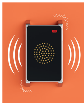
Alarma lumínica, acústica y vibratoria por temperatura corporal >37,8°C
