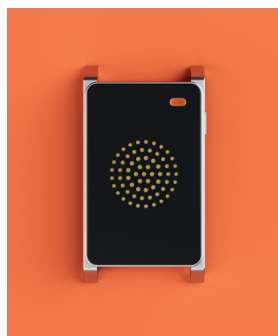
Alarma luminosa por temperatura ambiente >42°C
